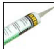
Arbo Meric 1020 1-komponent elastisk syrefast fuger- og klæbemasse 300 ml patron til almindelig fugepistol. Skønnet forbrug: 4-6 fuger pr. patron.
